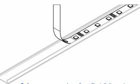
2. Assurez-vous que la surface d'installation est propre et sèche, retirez le film de protection et commencez appliquer la bande DEL.
